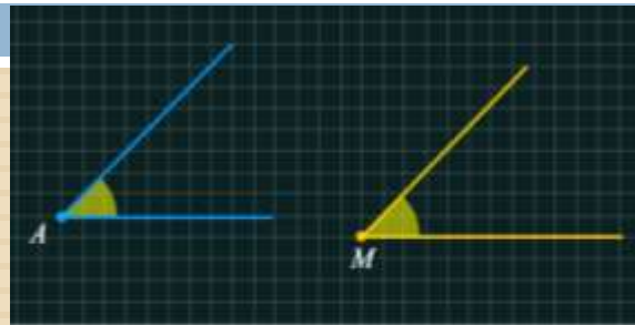
Итак, мы построили угол M , равный данному углу A , с помощью циркуля и линейки.
